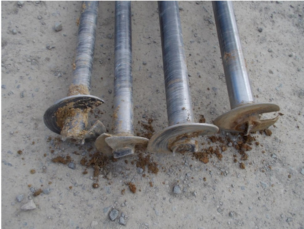
引抜き後の拡底翼
