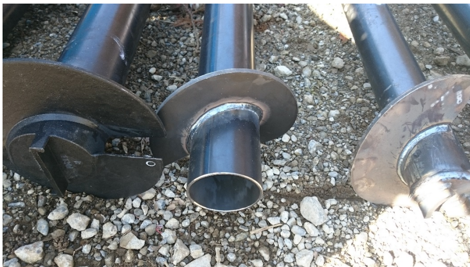
左より ALKTOP 工法、非認定拡底翼鋼管、 \alpha FP 工法 ※非認定拡底翼鋼管は、軸部が非閉塞
